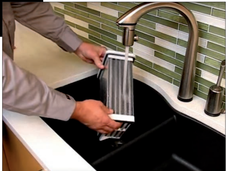
U klasické kondenzační sušičky je možné kondenzátor vyndat a vyčistit ho pod tekoucí vodou.
